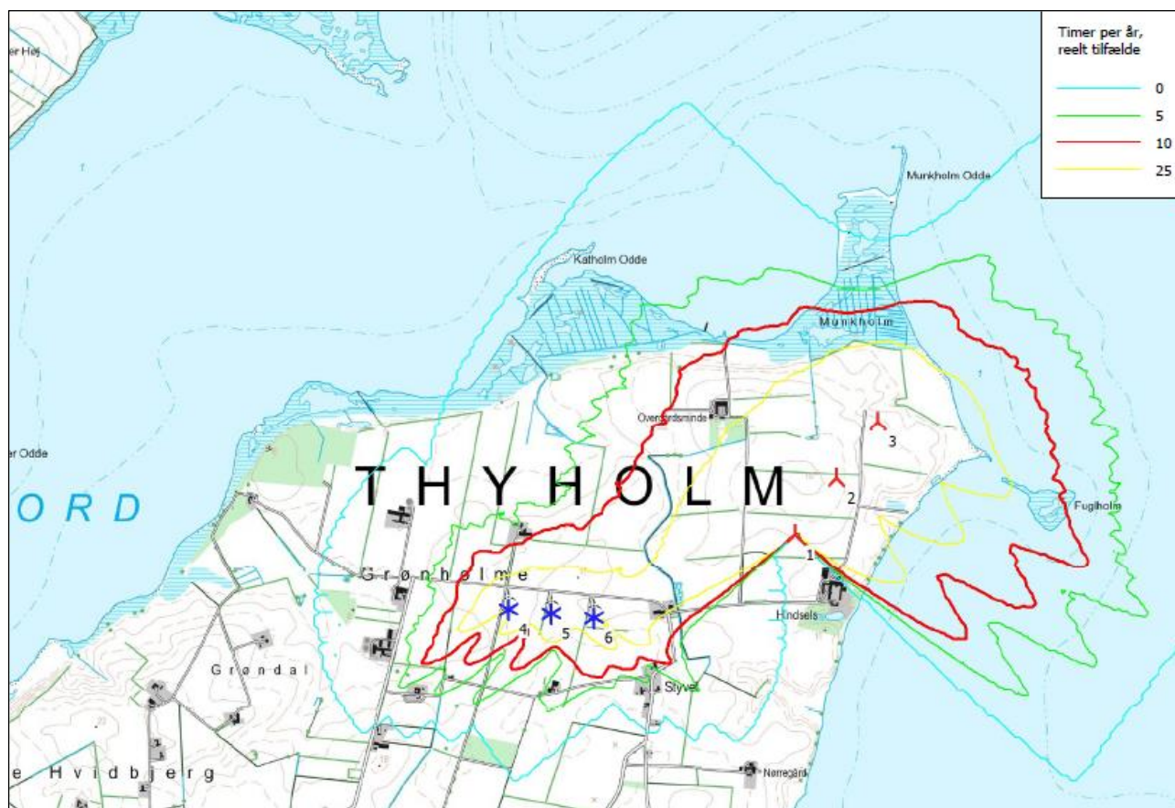
Figur 15. Skyggekast fra vindmøllerne. Den røde linje viser grænsen for, hvor der er mere end 10 timers skyggekast pr. år.
