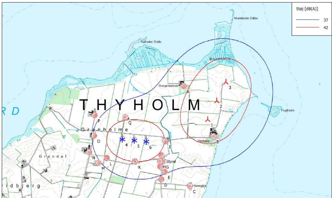
Figur 11. Støjberegning ved vindhastighed på 6 m/s. Den blå linje viser 37 dB(A) og den røde linje viser 42 dB(A).
