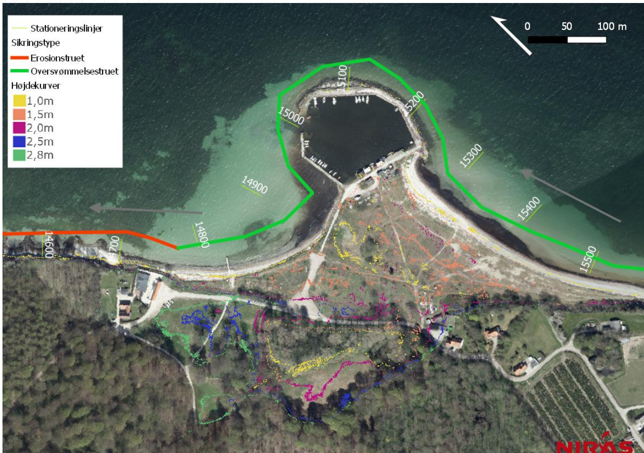
Figur 8.2: Oversigtskort over Lokalområde D, Bøgeskov Lystbådehavn, med stationeringslinjer, hvor det også ses hvilke områder der er erosions og oversvømmelsestruede. De grå pile angiver retning på sedimenttransporten. Ortofoto fra 2016.
