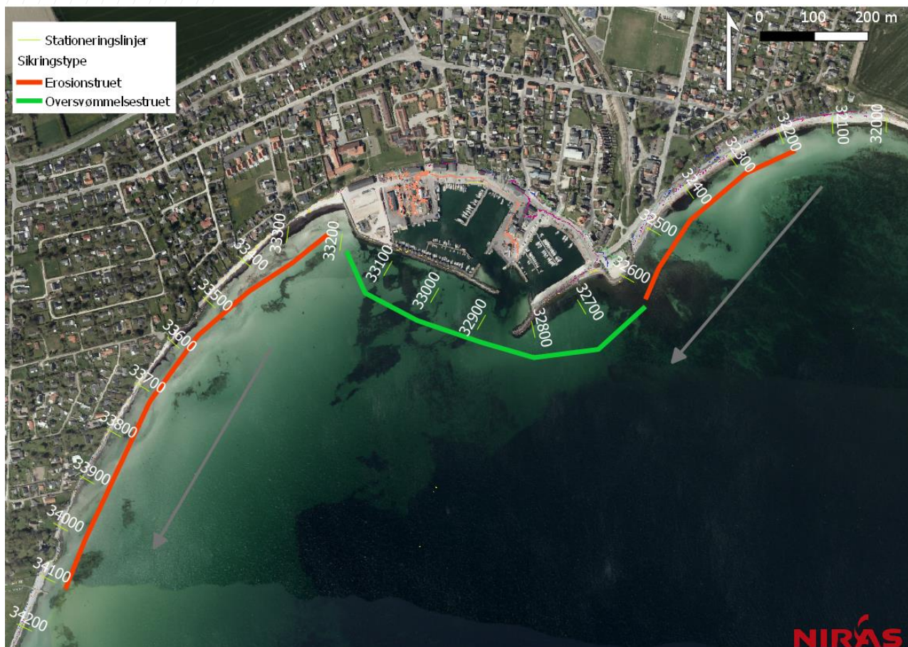
Figur 6.1: Oversigtskort over område 3 med stationeringslinjer, hvor det også ses hvilke områder der er erosions og oversvømmelsestruede. De grå pile angiver retning på sedimenttransporten. Ortofoto fra 2016.
