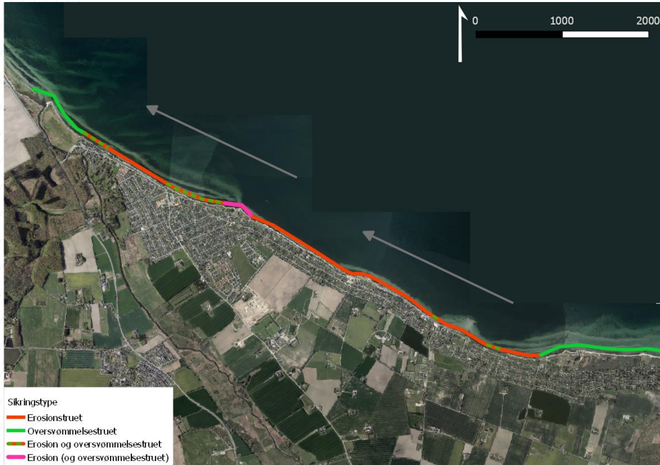
Figur 4.1: Oversigtskort over område 1 med angivelse af områder, der er erosions- og oversvømmelsestruede. De grå pile angiver retning på sedimenttransporten. Ortofoto fra 2016. Pink linje angiver et område, der primært er erosionstruet. Dog er bygningerne på strækningen også oversvømmelsestruet, men det er svært/bekosteligt at beskytte disse, også beskrevet i afsnit 4.7 og [1].
