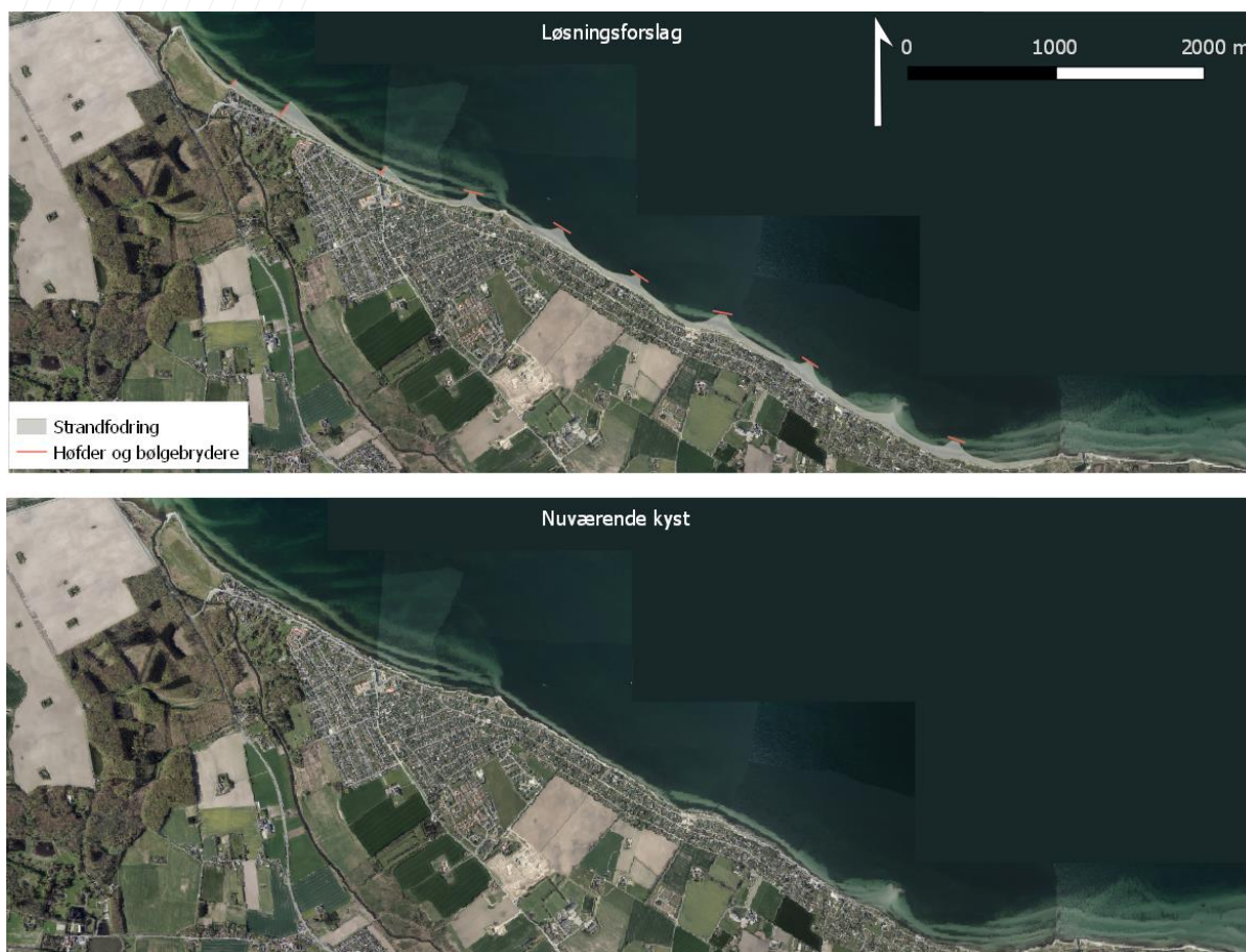
Figur 9.2: Forslag til en helhedsplan i område 1 og 2. Det strandfodres fra Tryggevælde Å og ned til Ved Vejs Ende og etableres høfder og bølgebrydere langs kysten med landværts beliggende diger. Nederste billede viser for reference kysten som den er i dag. Ortofoto fra 2016.
