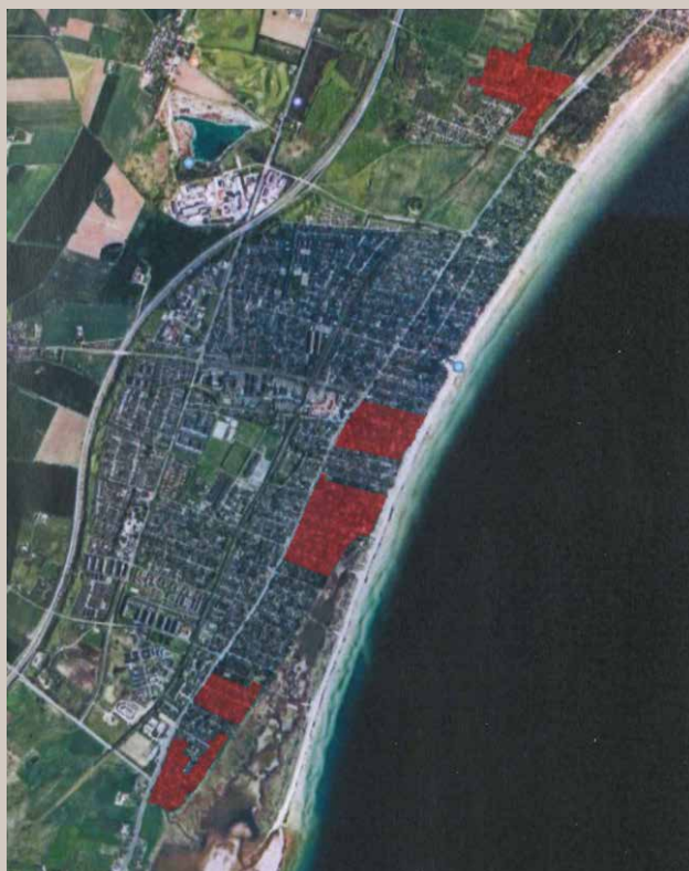
Figur 7 Resultat af undersøgelsen af uvedkommende vand. Oplande markeret med rød indeholder store mængder uvedkommende vand.
