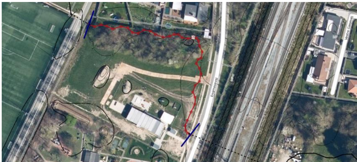
Figur 6-15 Litorinastien-Engmosevej, østlig del. Rørunderføring under skolestien samt åbent forløb med membran og sikring af vandløbssider. udskiftes
