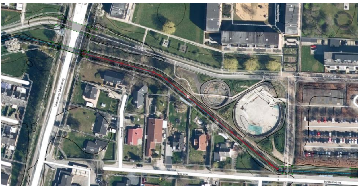
Figur 6-3 Taastrupvej-Mellemvang. Vandløb med dobbeltprofil og hævet bundløb.
