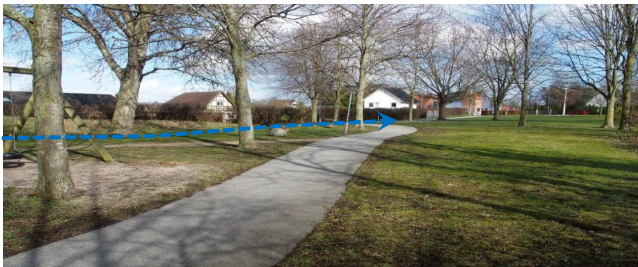
Figur 6-20 Fra Fasanvej føres vandløbet åbent gennem parken, der forventes omlagt til offentlig legeplads. Udgravning sker med så begrænset rydning som muligt. Nær transformertårnet rørlægges mod Strandvejen.
