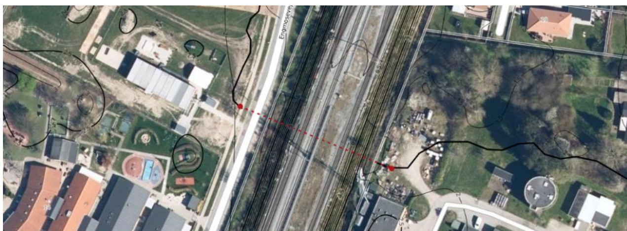
Figur 6-16 Engmosevej-jernbanen. Tunnelering under banedæmning. udskiftes
