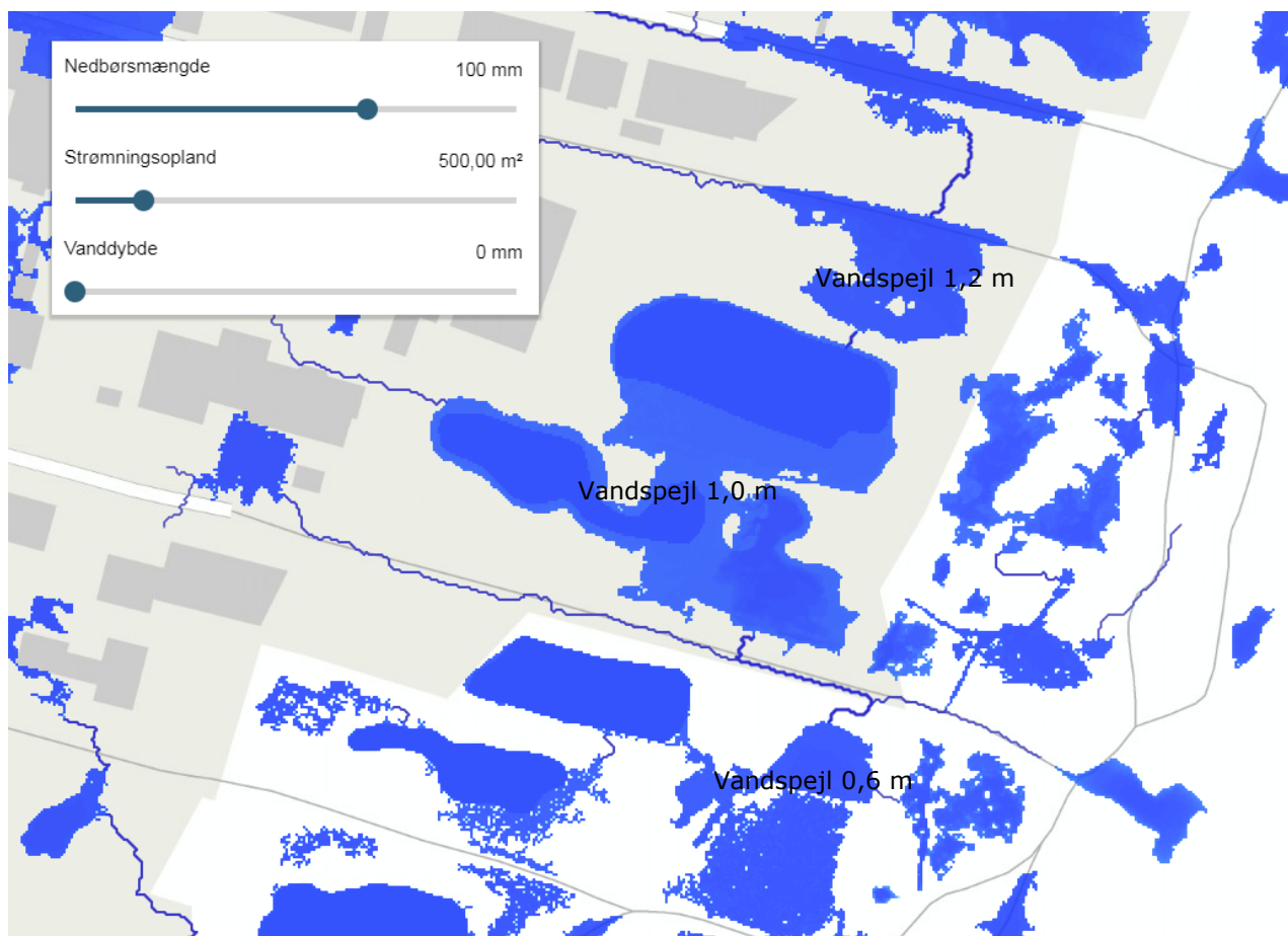
Figur 2-4: Skybrudskort beregnet med Scalgo Live for en nedbørsmængde på 100 mm (www.scalgo.com). Blå områder angiver vand på terrænet efter hændelsen. Blå linjer angiver strømningsveje på terrænet som hændelsen medfører.
