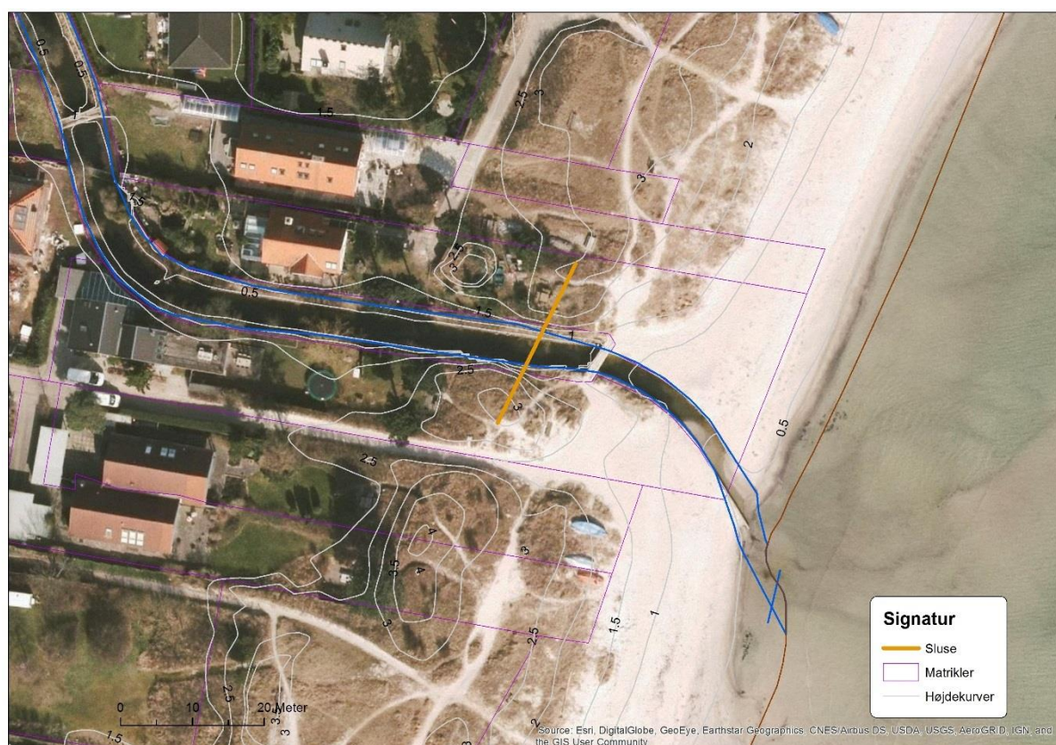
Figur 6: Højvandssikringskonstruktion ved Solrød Bæk
