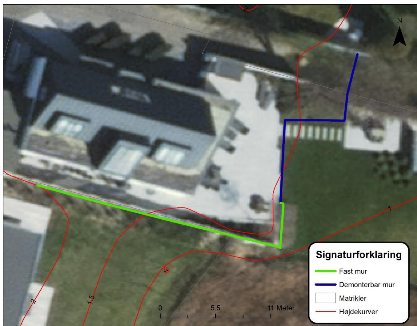
Figur 13: Oversigt med linjeføring af fast- og demonterbar mur
