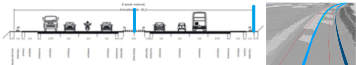
Figur 4: Placering af støjskærm på østlig side og midterrabbatten, snit set mod nord samt 3D billede fra SoundPLAN. Blå makering er støjskærmen.
