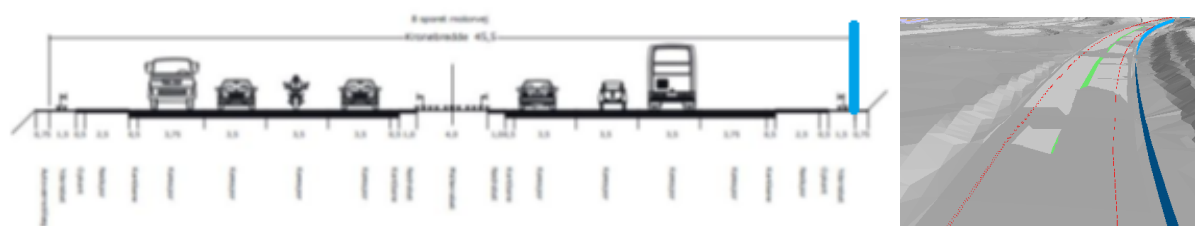
Figur 2: Placering af støjskærm på østlig side, snit set mod nord samt 3D billede fra SoundPLAN. Blå making er støjskærmen.
