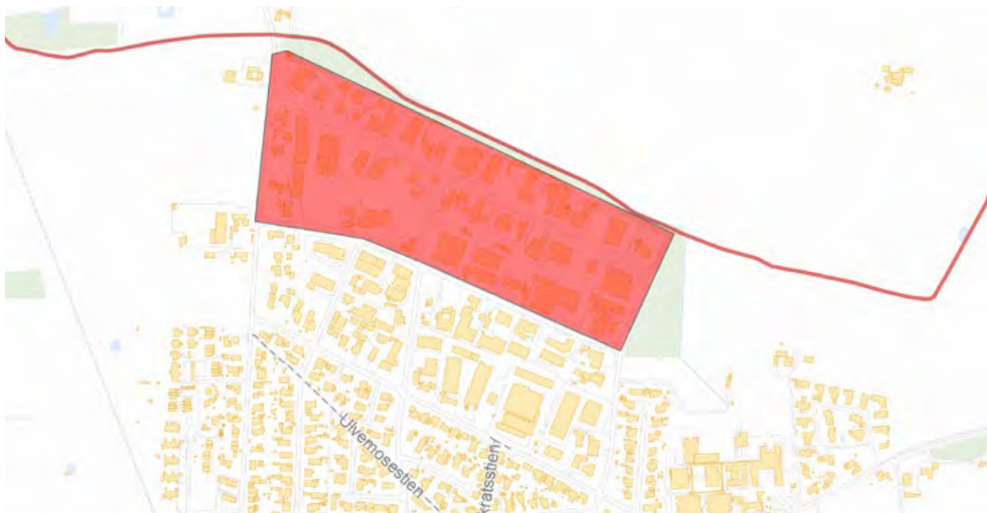
Figur 21 Industriområdet i Havdrup kan forsynes med fjernvarme fra en kollektiv varmepumpe baseret på en lokal vedvarende elforsyning.
