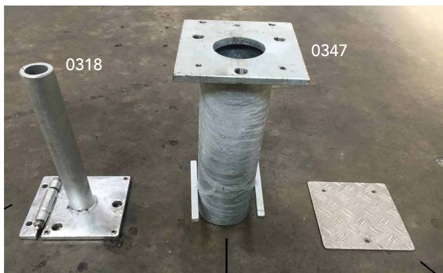
Nedstøbningsrør Rør Ø 100mm, Højde 500 mm Flange: 160 x 175 mm, varmgalvaniseret
