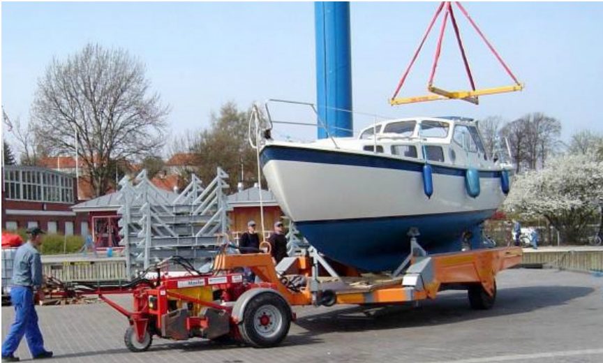
VOGN TIL STANDARDSTATIV MED BÅD PÅ VEJ I VANDET. I BAGGRUNDEN STABLEDE STANDARDSTATIVER.
