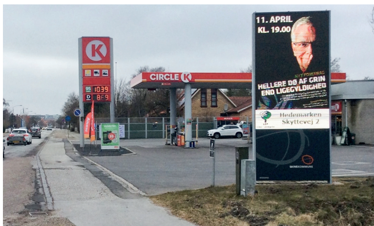
Figur 7: Lysreklame korrekt placeret uden for oversigtsareal ved tankstation. Til gengæld er oversigten i modsat retning begrænset af faste reklamer.
