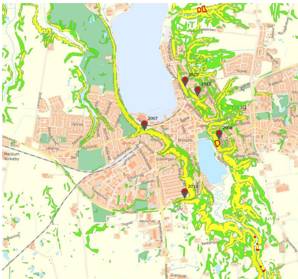
Kortlagte jordskred (Lemvig Kommune samt GEUS) sammenholdt med terrænhældning. Grøn indikerer en hældning på 6-12 grader og gul en hældning på over 12 grader. Se desuden bilag 1 og 2.
