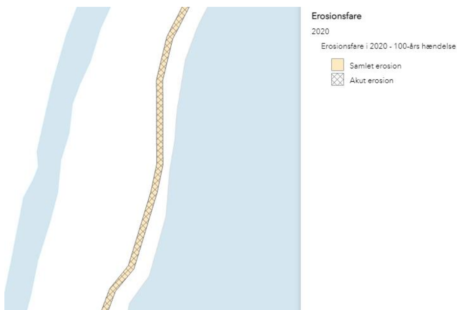
Figur 21: Estimerede erosionsforhold for en 100-års hændelse i år 2020 på strækningen "Plet Enge". (Kystdirektoratet, 2022c)
