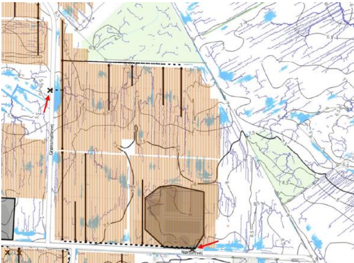
Figur 4: Østligt område efter der er etableret grøfter og drænedninger
