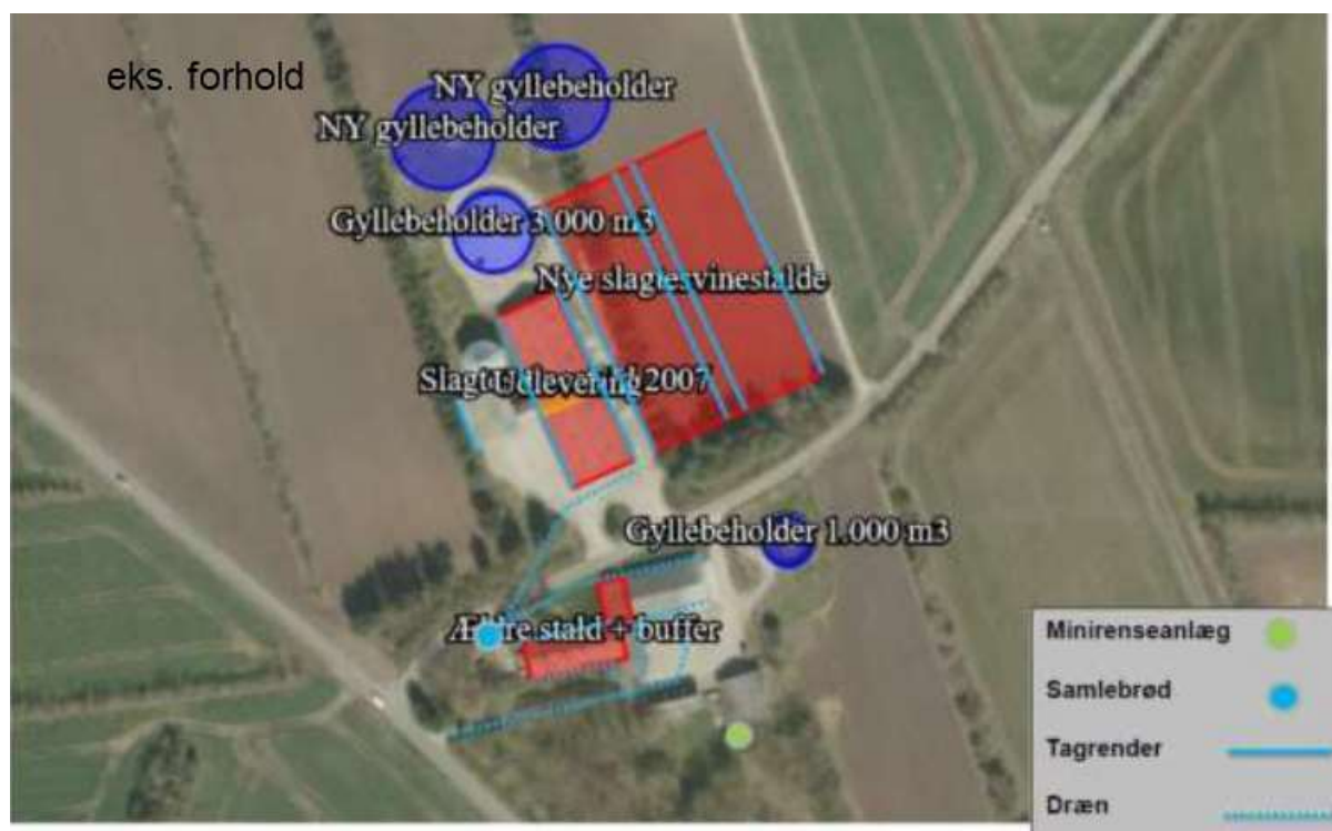
Figur 20: Oversigt over afløbsforhold for eksisterende anlæg.
