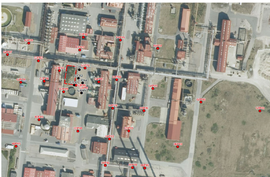
Figur 2 Oversigtskort med placering af det nedlagte IPE/PNF tanklager og beliggenheden af de pejlede og/eller analyserede borer (røde) samt afværgeboringerne G3D01-G3D05 (sorte).
