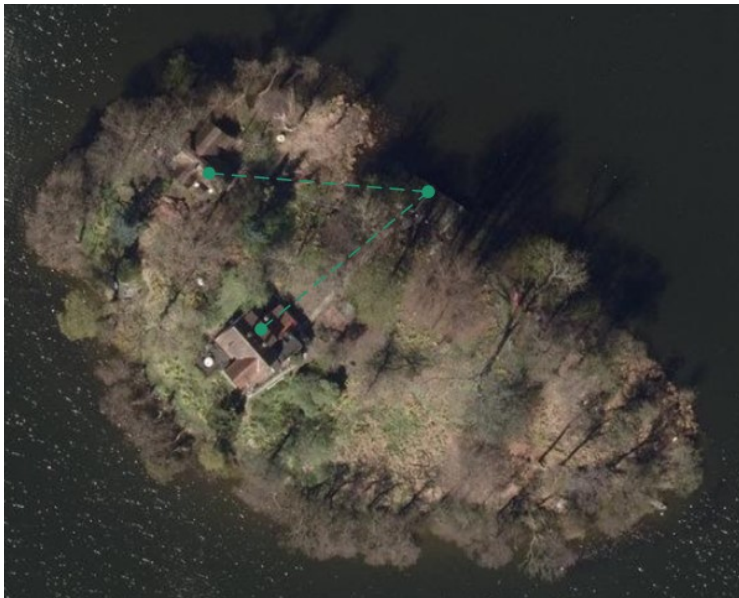
Figur 4. Der er ingen egentlige veje på øen, og derfor placeres vejpunktet på adressens nærmeste anløbssted. I dette tilfælde er anløbsstedet fælles for de to adresser på øen.
