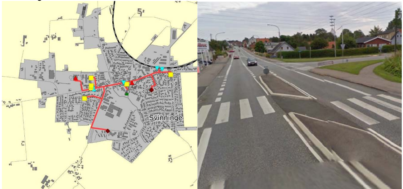
Billede 29: Tilgængelighedsrute i Svinninge samt eksempel på problem; forskudt overgang uden rækværk.
