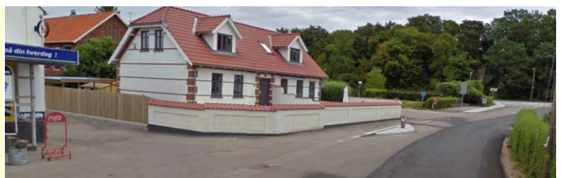
Billede 33: Tilgængelighedsrute i Gl. Hagested samt eksempel på problem; ingen afgrænsning mod kørebane.
