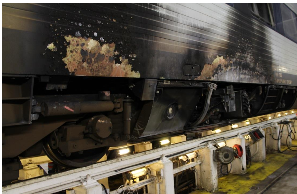
Fotos viser brandsporene ved hjulsæt og ved motor 1 (fotos viser højre side set i køreretningen).
