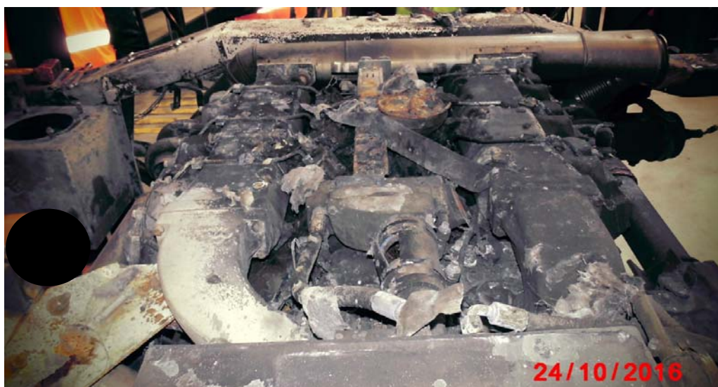
Billede 6. Skader på overside af motor
