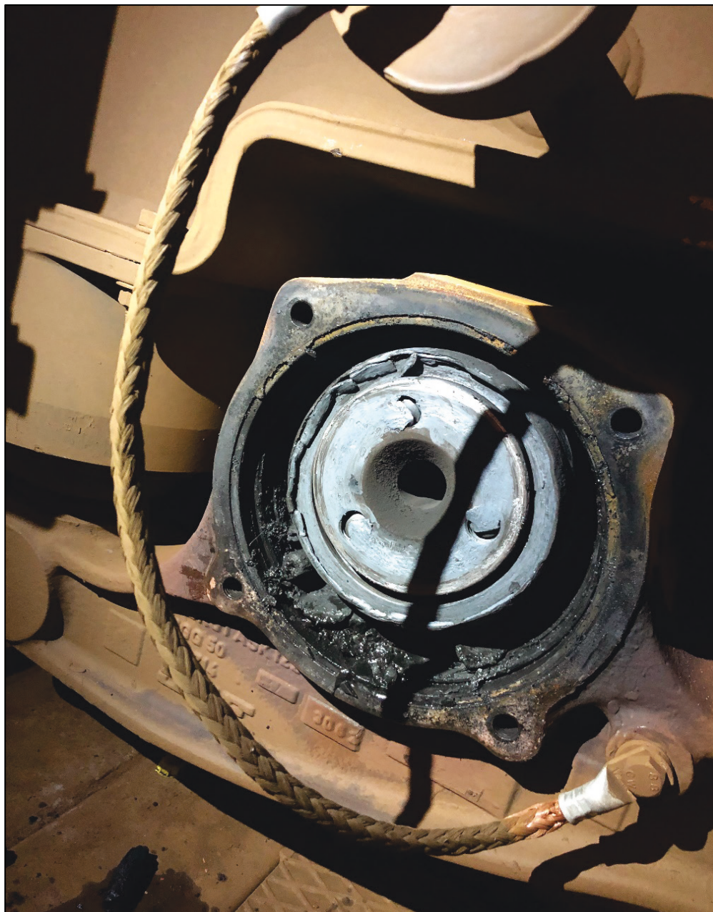
Foto 1. Defekt akselleje med tre knækkede trykkappeskruer. Kilde: NJ.
