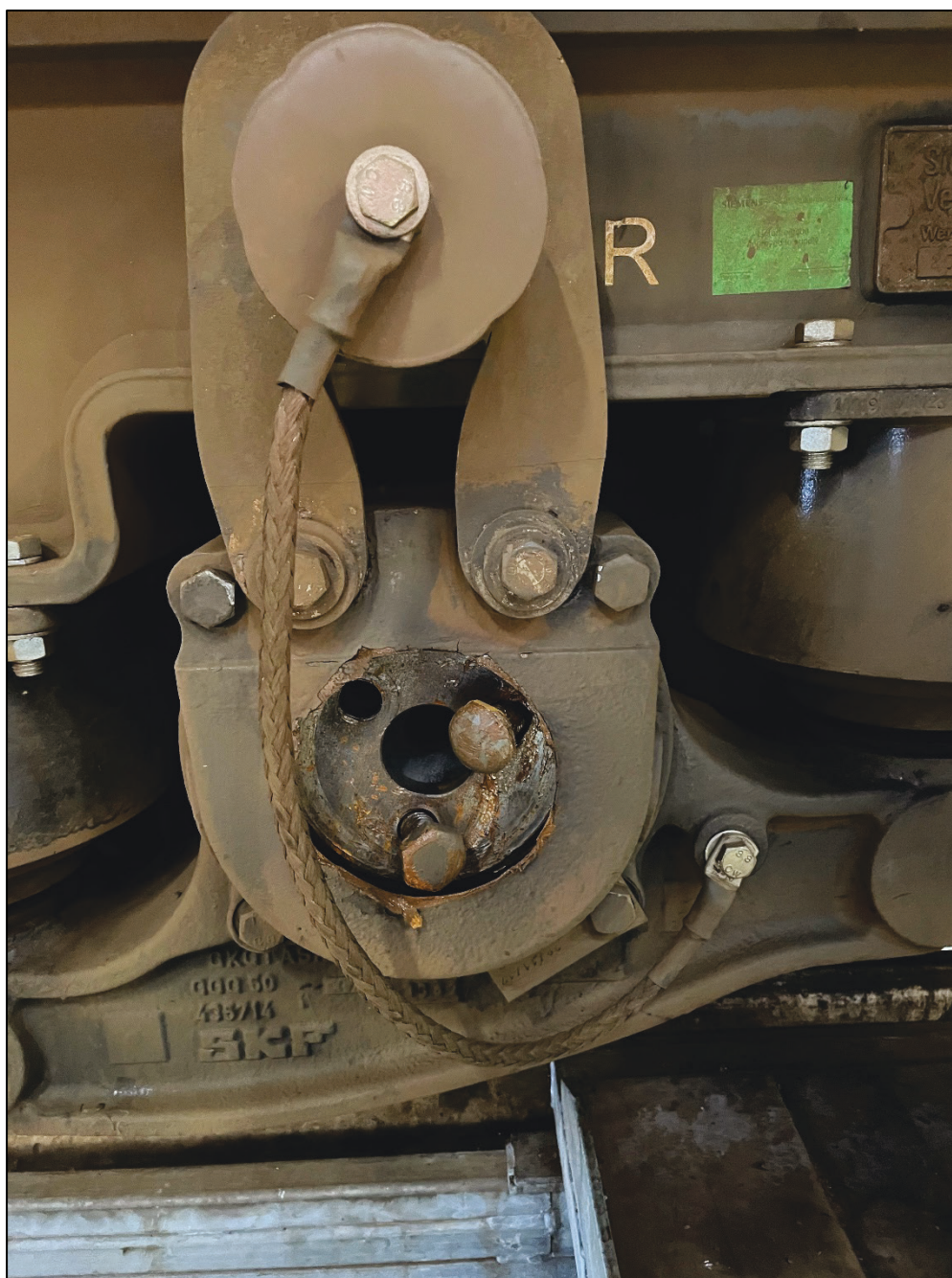
Foto 2. Skade på lejehuslåg pga. løse trykkappeskruer i maj 2021. Kilde: NJ.
