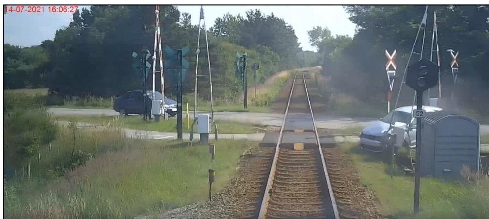
Figur 7. Optagelse fra togets bageste førerrum, der viser den påkørte bil holdende på cykelsti og i bomdrev tæt ved relæhytten. Overkørselssignalet fra Hirtshalssiden er også slukket.
