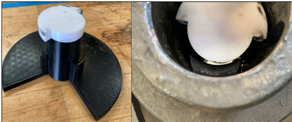
Foto 14: Specialfremstillet hovedbolt med udskæring og den involverede låsepal og kongetap i skammel set nedefra.
