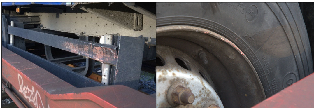
Foto 7: Cykelistværn ses bøjet og påført maling fra vognens kant. Mærker på dæk og maling på fælg.
