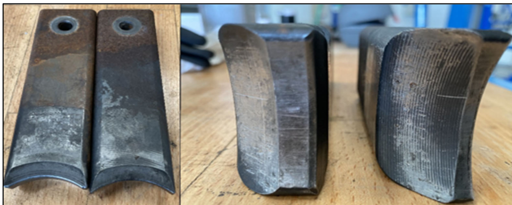
Foto 13: De undersøgte låsepaler, den til venstre er den involverede låsepal og den til højre er fra skamlen i den modsatte ende af vognen.
