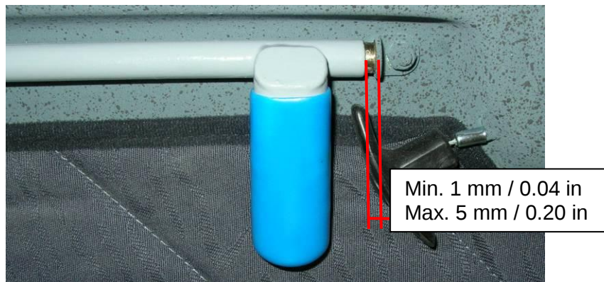
Bild / Picture 3: Einstellung Bremsklappen-Gestänge / Adjustment of airbrake control system
