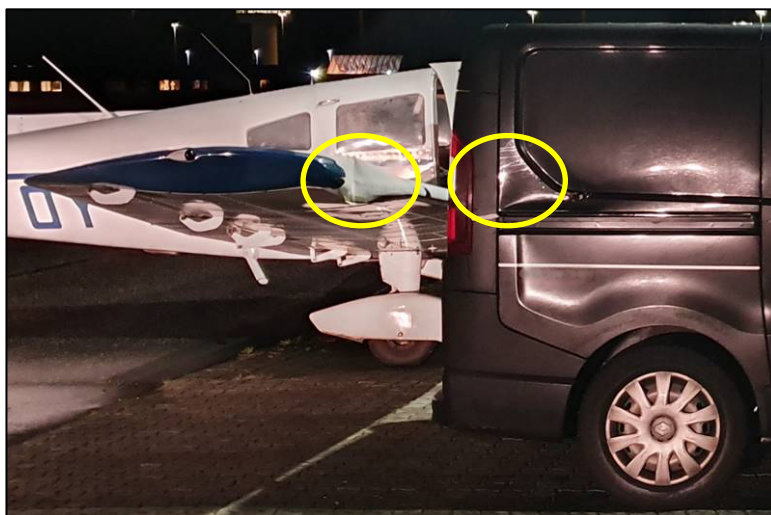
Billede 1: Skade på flyets højre vinge nær vingetippen samt på den bageste del af varebilens højre side.
