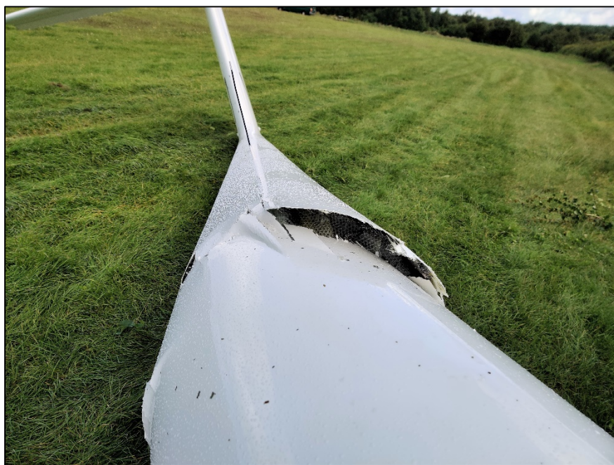
Billede 3 - Svæveflyets bagkrop brækkede bag cockpitsektionen og vingerne - fotograferet fra cockpitsektionen.
