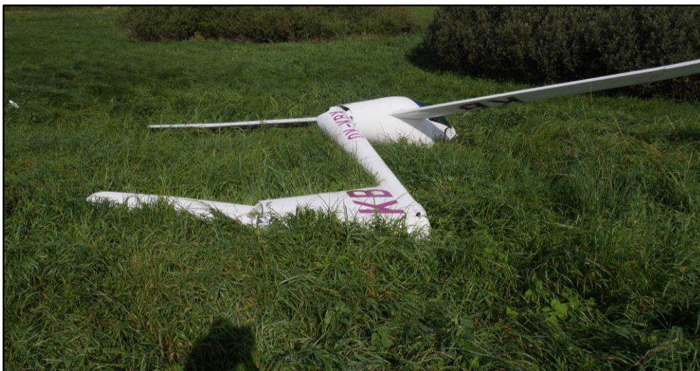
Separeret halebom og horisontalt haleplan
