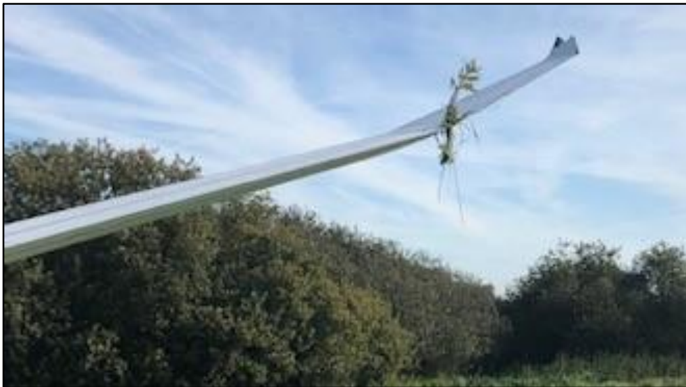
Skade på højre vinge
