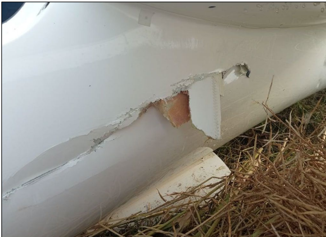
Foto 3: Skader på venstre side af kroppen på OY-SEX lige under venstre vingeforkant. Dele fra D-2691 sad stadig fast.
