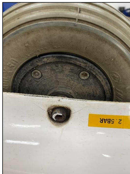
Billede 2 - Revner på understelsstruktur
