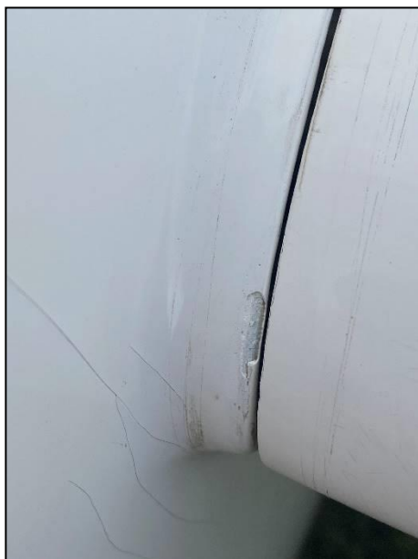
Billede 1 - Revner på vinge og krop
