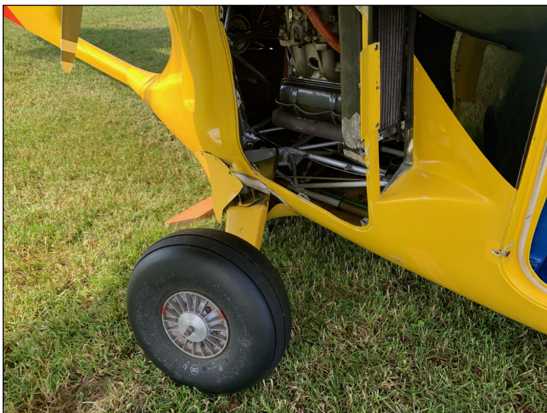
Billede 1 – Skade på det højre hovedhjulsunderstel og motorsvæveflyets struktur.
