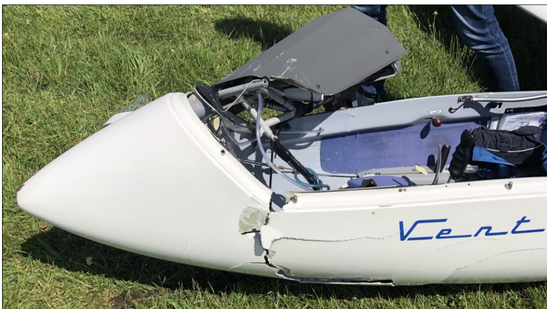
Billede 2: Strukturelle skader på næsepartiet
