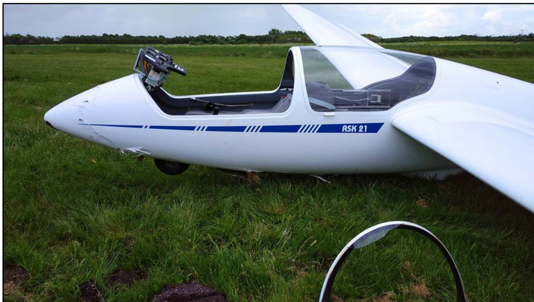
Billede 1 – Venstre side af flyet, hvor skader ses på næsesektionen. Rammen til plexiglasdelen af hooden ses foran venstre vinge.
