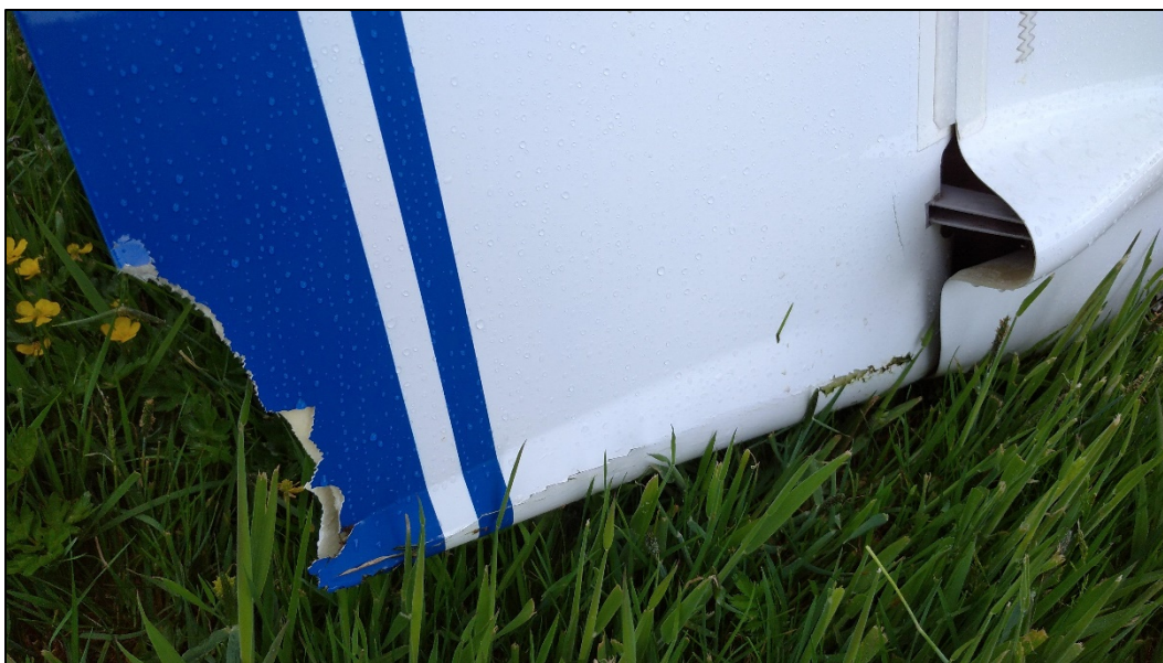
Billede 4 – Skader på den nederste del af sideroret.
