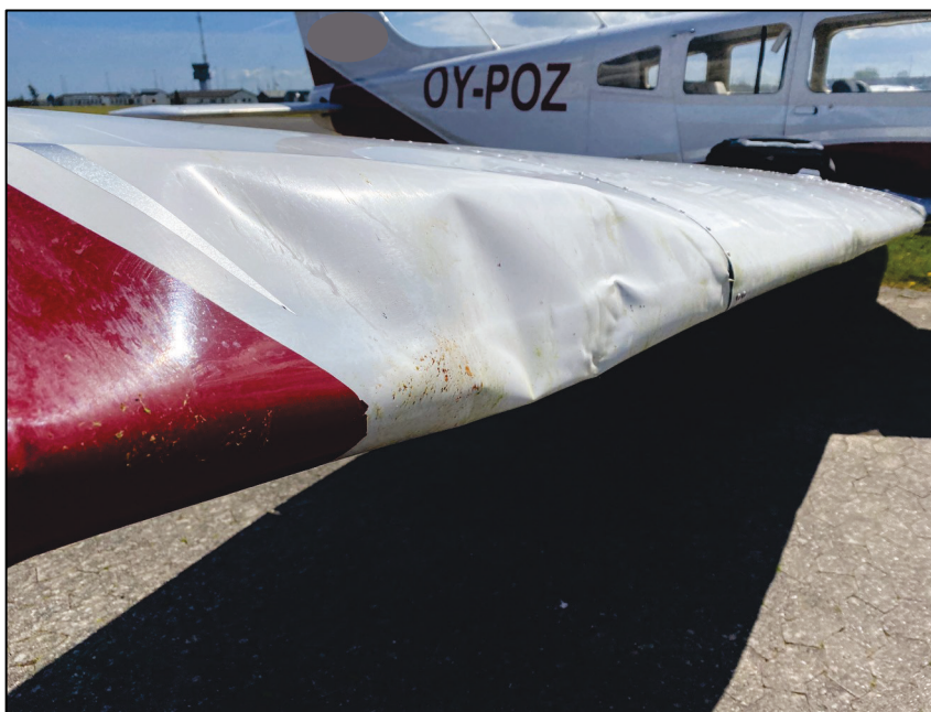
Figur 1. Skade yderst på højre vinge. Havarikommissionen har skjult flyveskolens logo.
