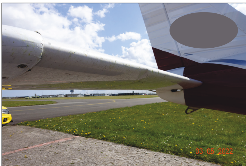
Figur 2. Skader og skrabemærker på haleplanet. Havarikommisionen har skjult flyveskolens logo.
