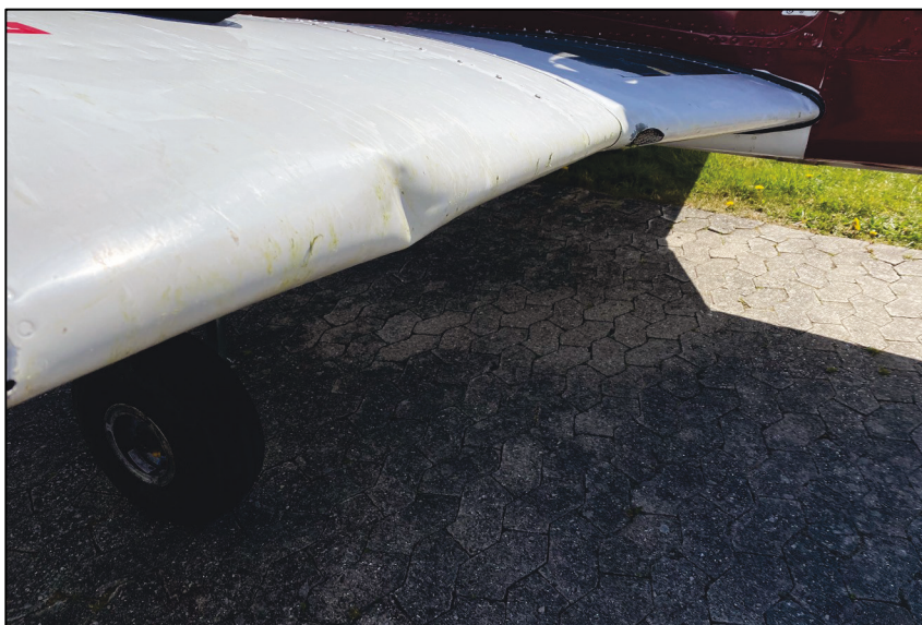
Foto 1. Skade inderst på højre vinge.
