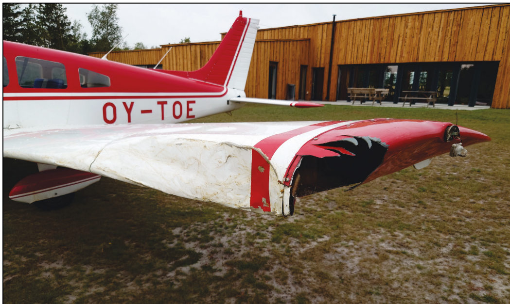
Foto 2. Skader på venstre vingeforkant og venstre vingetip.
