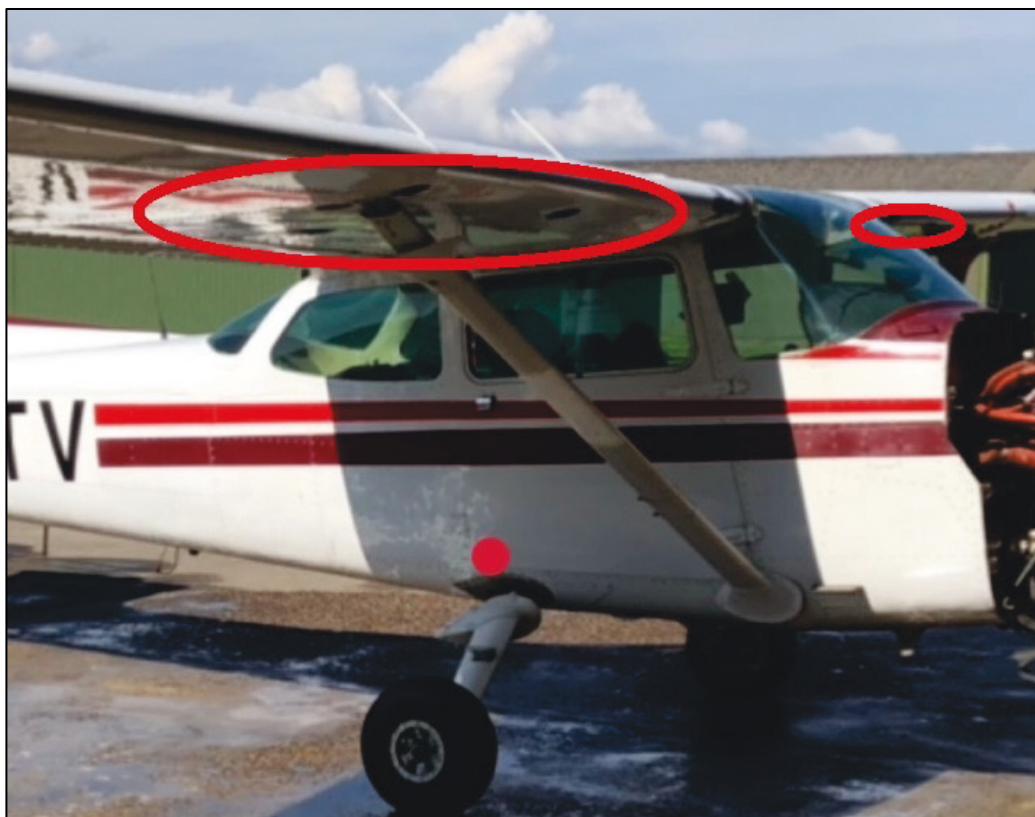
Figur 1. Skadesområderne markeret med røde ovaler (buckling) og en rød prik (dørstople).
