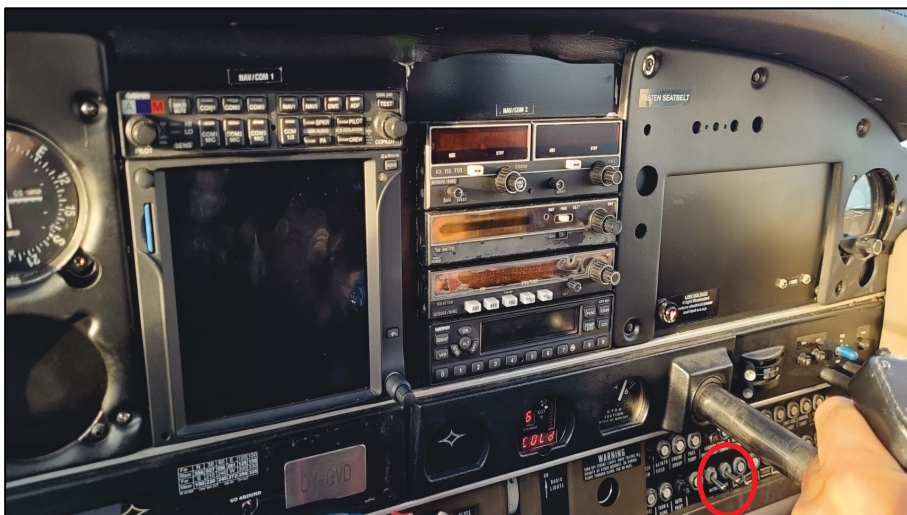
Figur 1. Foto taget af piloten under flyvning. De to hovedafbryderkontakter til kommunikations- og navigationshjælpemidlerne er markeret med en rød cirkel.
