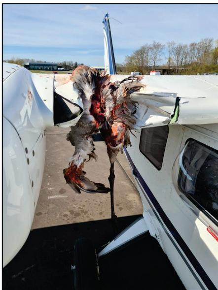
Foto 1. Skade på højre vingeforkant.
