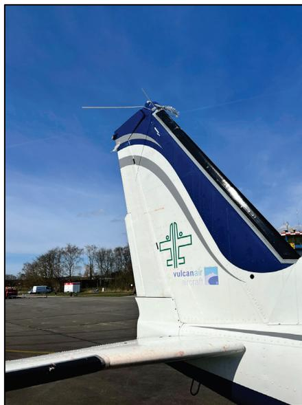
Foto 2. Skader på antenne og sideror.
