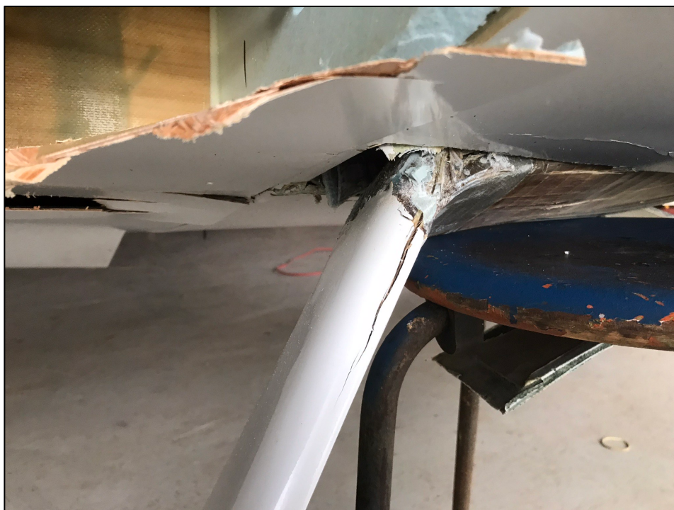
Foto 3. Skader på højre hovedhjulunderstelsben
