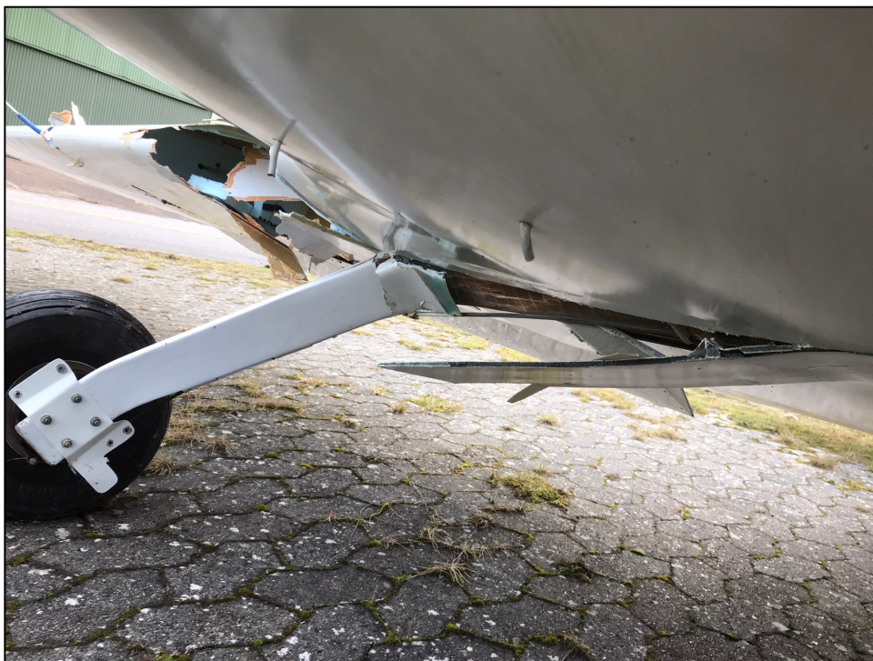
Foto 1. Skader på højre vingeforkant og undersiden af flykroppen mellem hovedhjulunderstelsbenene
