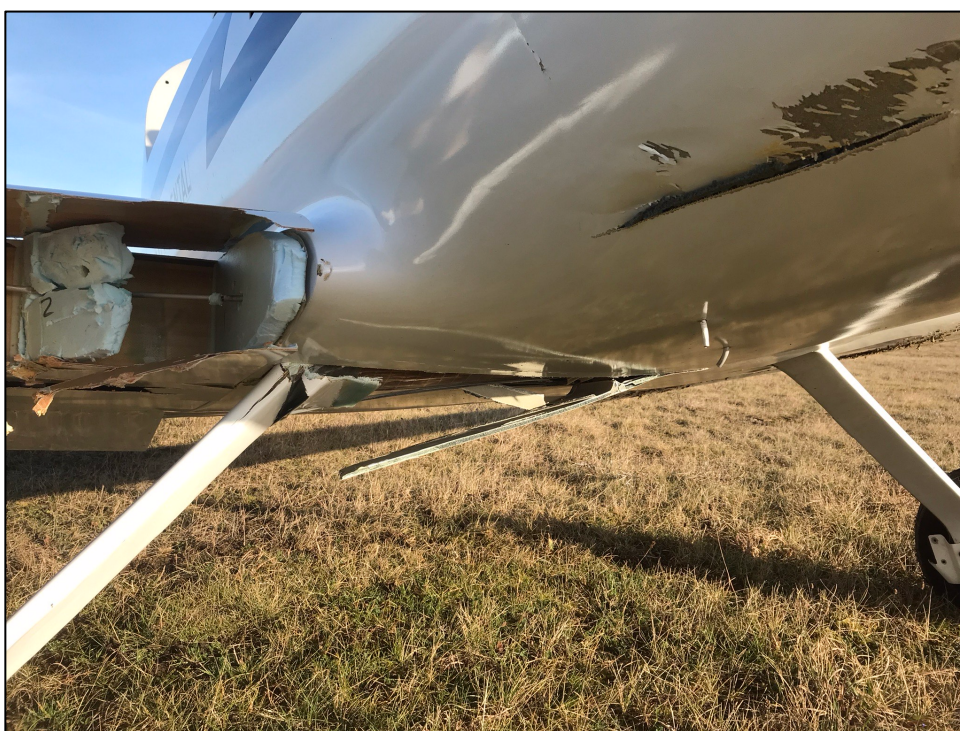
Foto 2. Skader på højre vingeforkant og undersiden af flykroppen foran hovedhjulunderstelsbenene
