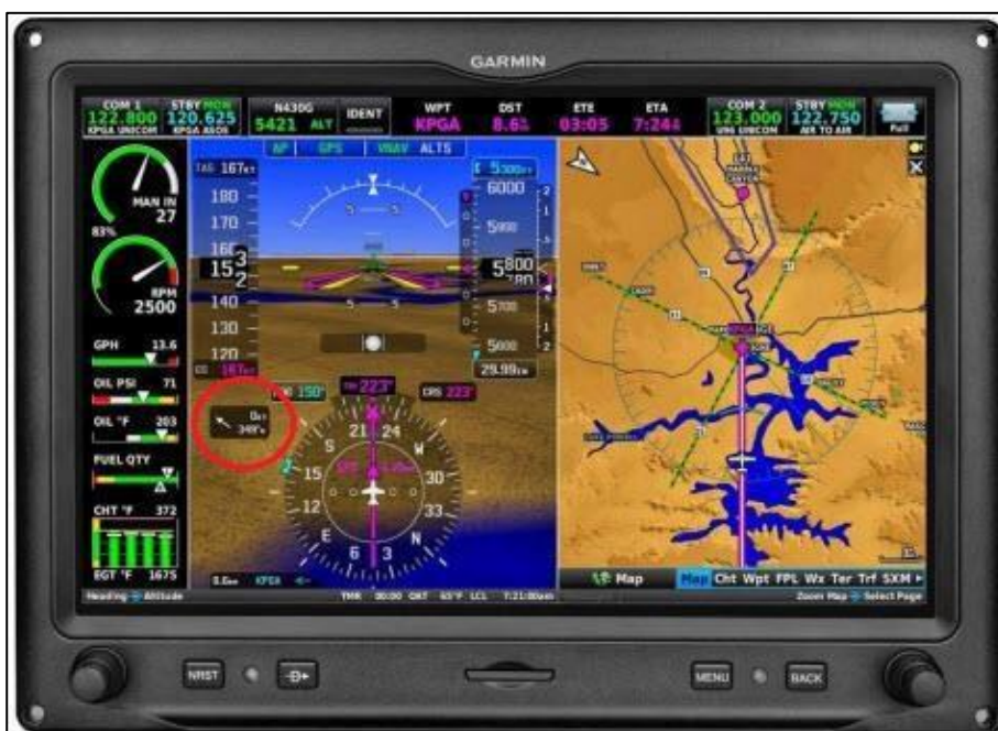
Figur 1. Illustration fra flyets AFM der viser PFD. Vindindikationen er vist ved en rød cirkel.
