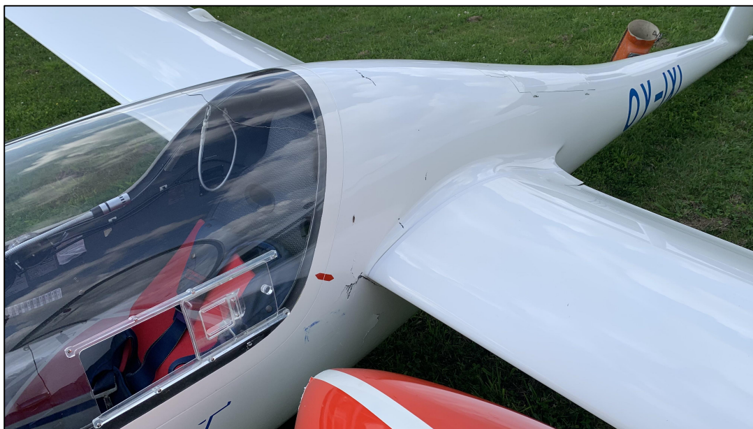
Foto 2. Skader på kroppen og canopy på det parkerede svævefly.
