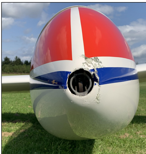
Foto 1. Skade på svæveflyets næseparti.
