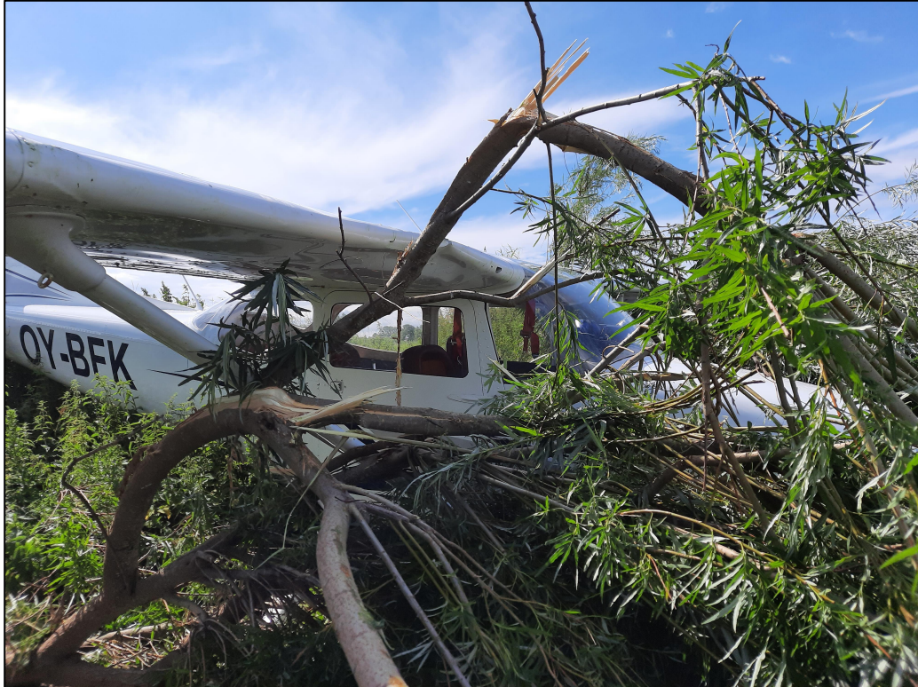
Foto 1. Strukturelle skader på flyet efter kollision med piletræer for enden af bane 29.
