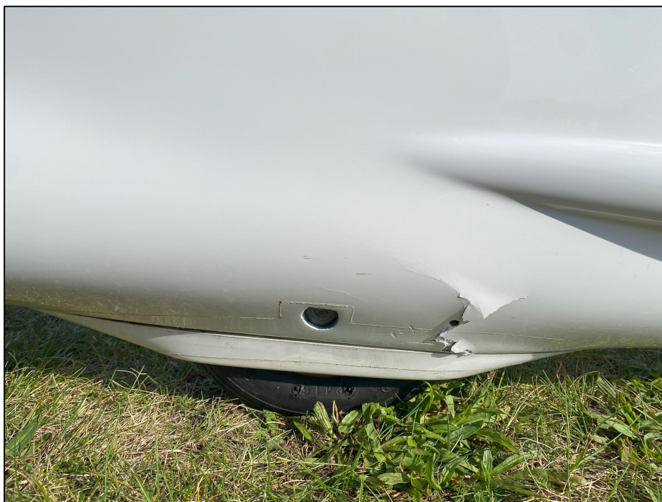
Foto 1. Større strukturel skade i glasfiberkonstruktionen omkring svæveflyets halehjul.
