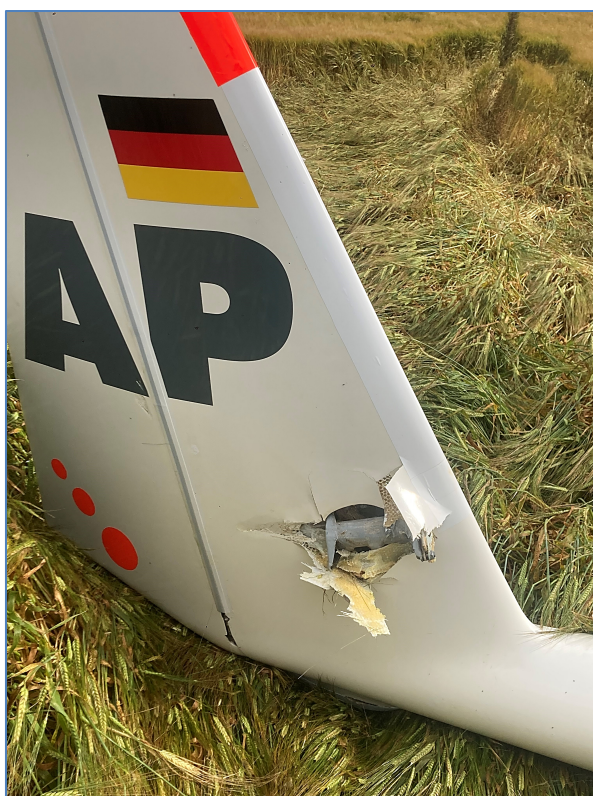
Foto 1. Et ødelagt højderorsbeslag.
