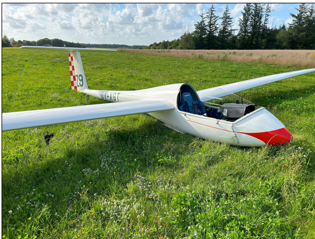
Foto 1. Skade på svæveflyets næseparti og canopy.
