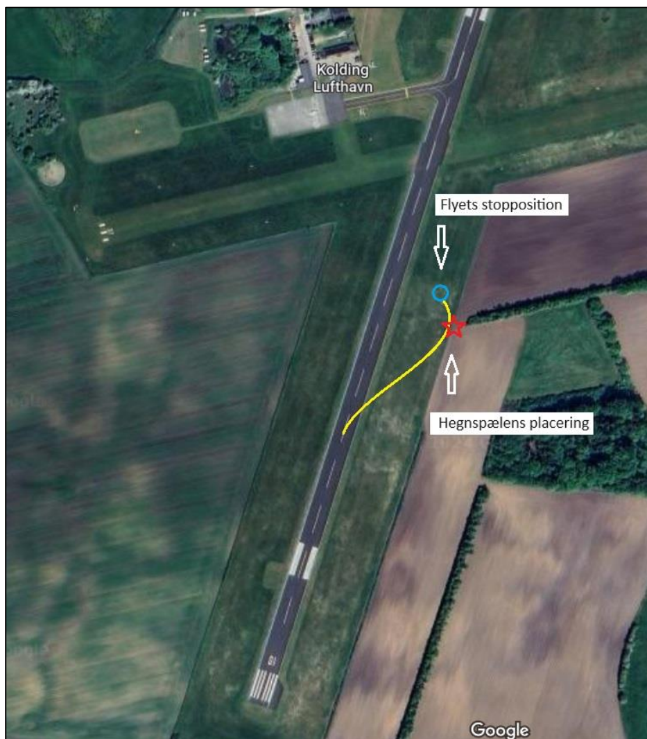
Figur 1. Figuren viser et oversigtsbillede af Kolding/Vamdrup Lufthavn. Flyets afløb ud over baneafgrænsningen er markeret med en gul streg, hegnspælen er markeret med en rød stjerne og positionen hvor flyet stoppede er markeret med en blå cirkel. Afstanden fra banens centerlinje til den højre begrænsning af sikkerhedszonen, hvor hegnspælen var placeret, var 75 meter.
