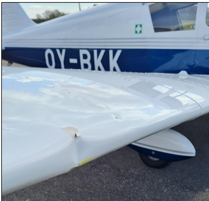
Foto 1. Skaden på højre vingeforkant.
