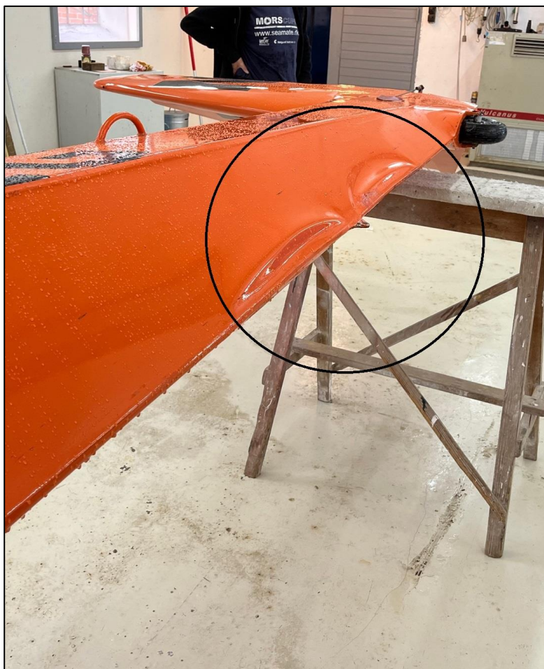
Figur 1: Skader på nedre del af svæveflyets bagkrop/hale.
