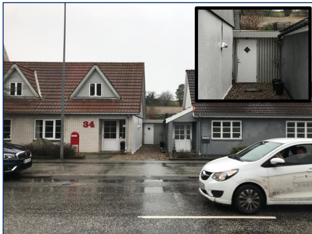
Figur 38. Boligerne skærmer for støjen, men der kommer støj ind gennem smøgen mellem de to huse. Ved at sætte et hegn (her også med en dør) i smøgen, er støjen i baghaven dæmpet mærkbart.
