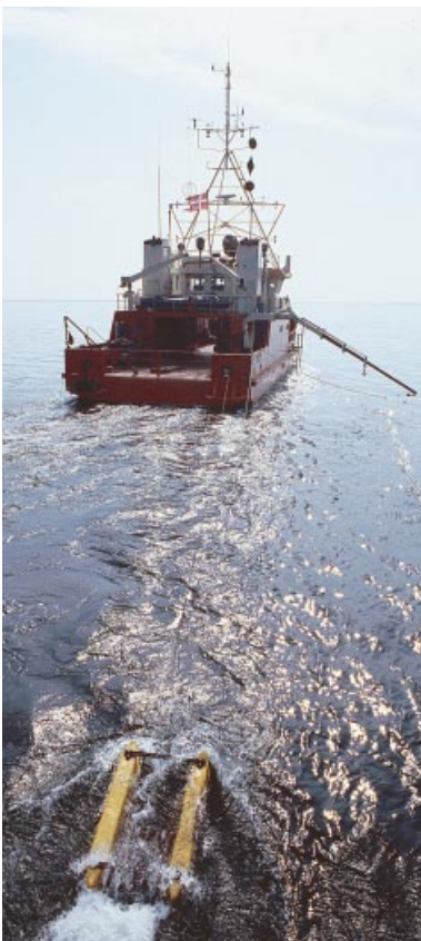
Figur 7. Sejlads med seismisk udstyr til kortlægning af sand, grus og ral.
