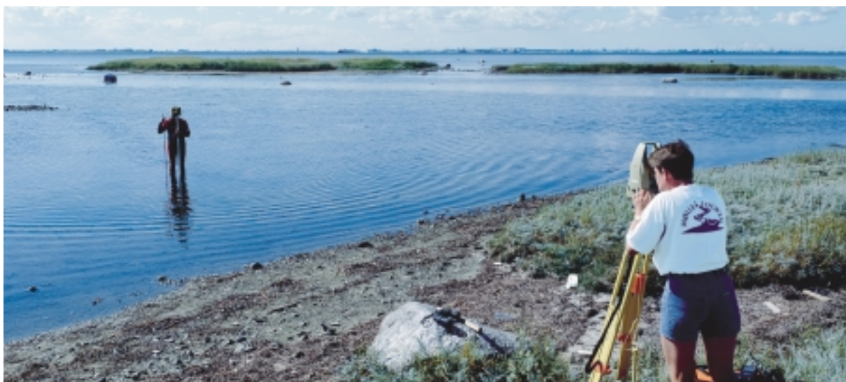
Figur 10. Opmåling af profil på den sydvestlige del af Saltholm. Opmålingen finder sted med teodolit fra land. Bemærk fikspunktet, det gule rør, under teodolitten nederst i billedet (se pilen).
