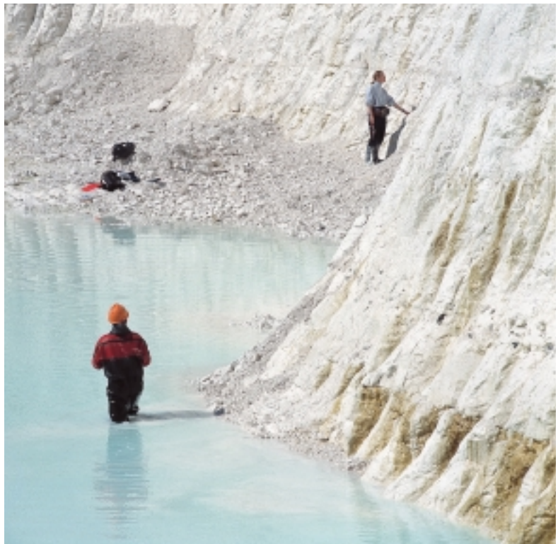
Figur 3. Faxe Kridt A/S kridtbrud ved Sigerslev på Stevns. Der opmåles sprækker i forbindelse med det EU støttede projekt "Fracflow". Projektet går ud på at undersøge opsprækket kridt med hensyn til strømning af grundvand gennem sprækkerne.
