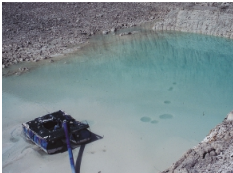
Figur 7. Billede af udstømmende vand fra sprække i sø i bunden af kridtgraven. Bunden af søen er dækket af kridt slam, og det udsivende vand danner kratere i slammet.
