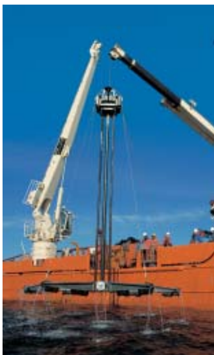
Figur 5. Opmålingsfartøjet "Gunnar Seidenfaden" i færd med at foretage 6 m lange vibrocore borer.
