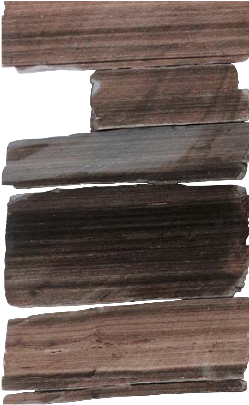
Figur 10. Gennemskåret borekerne fra et af de lærige intervaller i Nord Jens-1 boringen. Den meget fine, uforstyrrede lamination viser at sedimentet ikke har været forstyrret af gravende organismer. Dette tyder på at sedimentet blev aflejret mens der herskede iltfattige forhold på havbunden. Denne bjergartstype har dårlige reservoiregenskaber.
