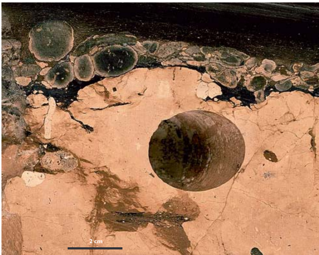
Gennemskåret borekærne. Kærnen er fra Adda-1 boringen. Billedet viser en hærtnet kalkhorizont i toppen af sekvens CK-3 (se Figur 4). På den uregelmæssige, hærtnede flade ligger et tyndt lag kalkkonglomerat og fint lamineret sort mergel.
